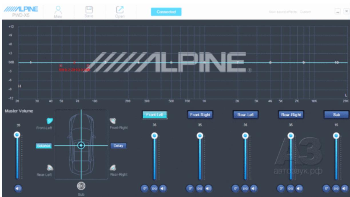
Основной (можно сказать – единственный) экран. Отсюда производятся настройки каналов и отсюда же вызываются всплывающие окна дополнительных режимов. Здесь же можно «спарить» каналы для синхронизации настроек, инвертировать сигнал и сохранить до шести настроек
