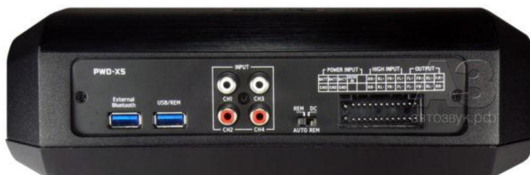
Компоновка устройства вполне традиционная для «подседельных» сабвуферов, габариты 350 x 245 x 80 мм. Кроме двух пар линейных входов и колодки входов высокого уровня, питания и выходов с коммутационной стороны переключатель активации устройства (по сигналу Remote или по постоянной составляющей на входах высокого уровня) и два порта USB. Один – для настройки с компьютера и подключения пульта ДУ, второй – для входящего в комплект модуля Bluetooth
