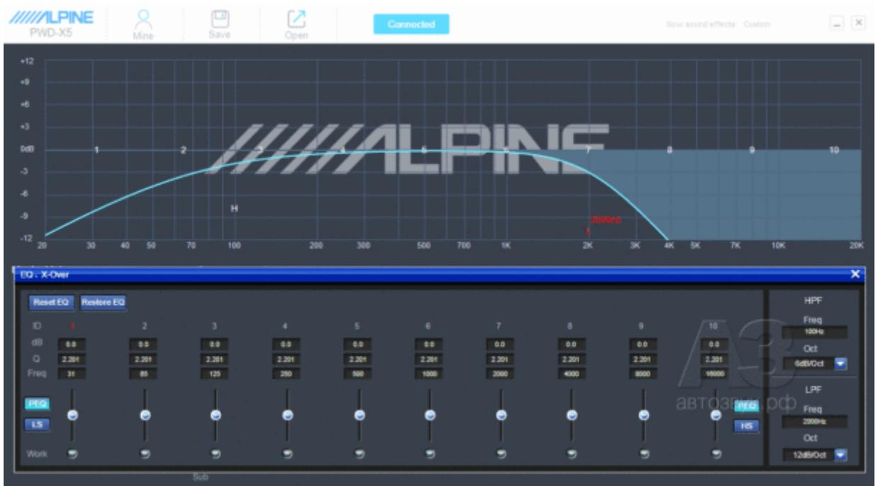
Для настройки кроссовера и эквалайзера нужно кликнуть по АЧХ. Для каждого канала предусмотрен цифровой кроссовер (ФВЧ, ФНЧ, полосовой) с выбором частоты среза в пределах 20 Гц-20 кГц и крутизны (6 или 12 дБ/окт)
