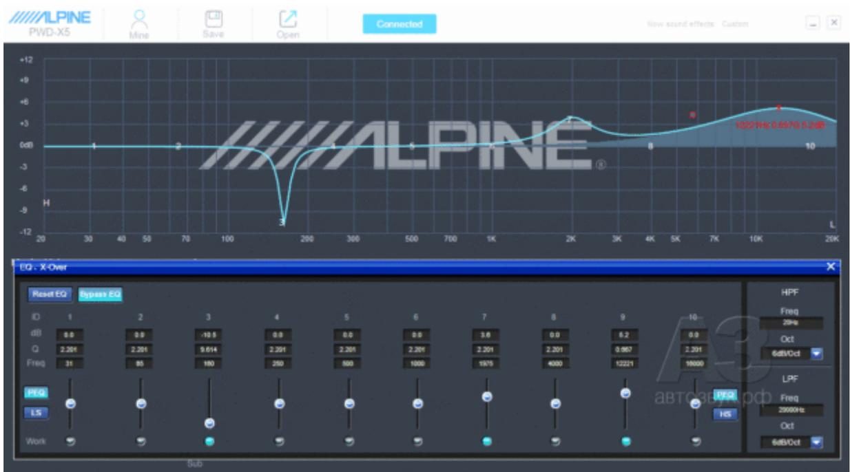
Для каждого из четырёх основных каналов предусмотрен отключаемый десятиполосный параграфический эквалайзер. Можно выбирать центральную частоту каждой полосы, добротность от 0,404 до 28,85(!) и усиление от -12 до +12 дБ. Можно вводить цифры вручную в соответствующем окошке, можно двигать мышкой маркеры ширины полосы, частоты и уровня (на скриншоте это видно в полосе 12,22 кГц)
