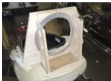
Из бальзовых сегментов выклеивается передняя стенка
