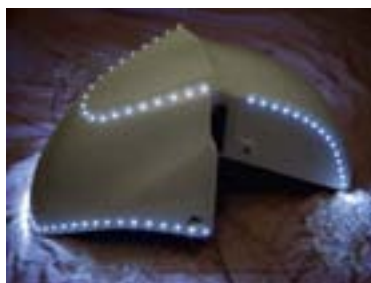
Иллюминация в переднем крыле: залитые компаундом цепочки светодиодов
