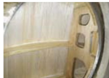
Внутри, разумеется, оболочка подкреплена рёбрами (тоже бальзовыми)
