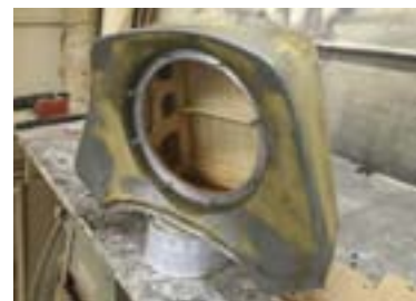
Окончательные свойства корпусу придаёт третий крылатый материал — стеклопластик
